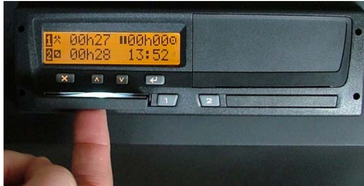
Figura 7 Retirada de tarjeta de la ranura
